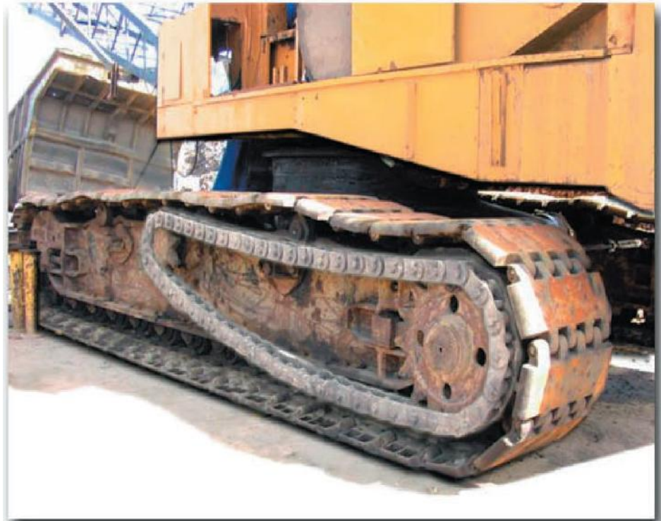
Cadena de Clase Ingeniería alimenta el equipo de esta grúa. Nota: Para cadena "offset" (acodada) en aplicaciones pesadas, la dirección correcta para correr la cadena es con el lado pequeño hacia adelante del lado mas grande.
